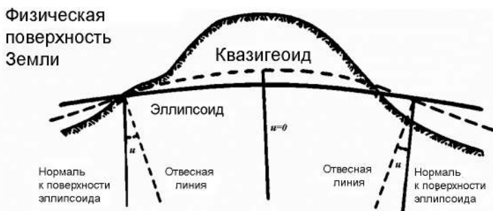
Рис. 3.1. Нерегулярная поверхность геоида, аппроксимирующаяся регулярным эллипсоидом 1
